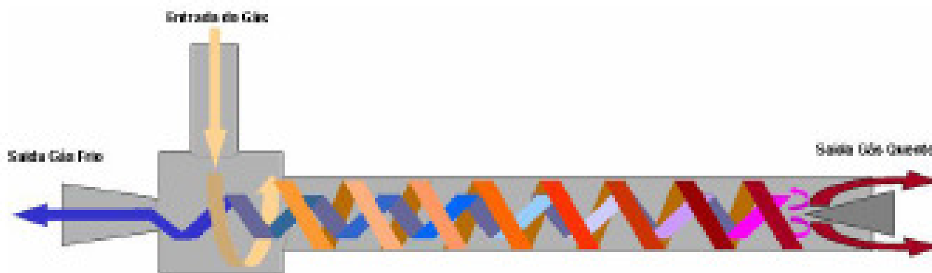
FIGURA II Esquema de funcionamento do TUBO VORTEX SEPARADOR®
